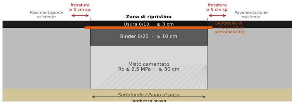
Tav. A1 — Sezione trasversale tipo: scavo tradizionale con geosintetico
